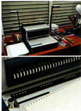
工房スペースにあるGBC社のリング製本機で製本する。紙にリング穴をあけたあととリングをはめてプレスする。
